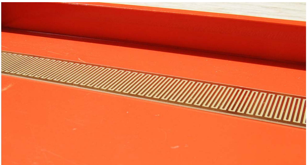
Anwendungsbeispiel: Sensorplatine KWS-3 in einer Auffangwanne für Kondensat
